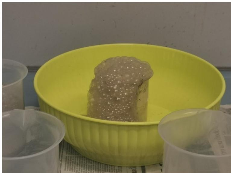
*Figura 28: Formazione di schiuma causata dalla reazione con l'acqua ossigenata
