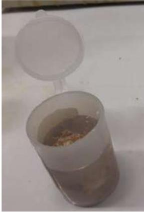
Figura 88 - Campione immerso nella resina bicomponente
