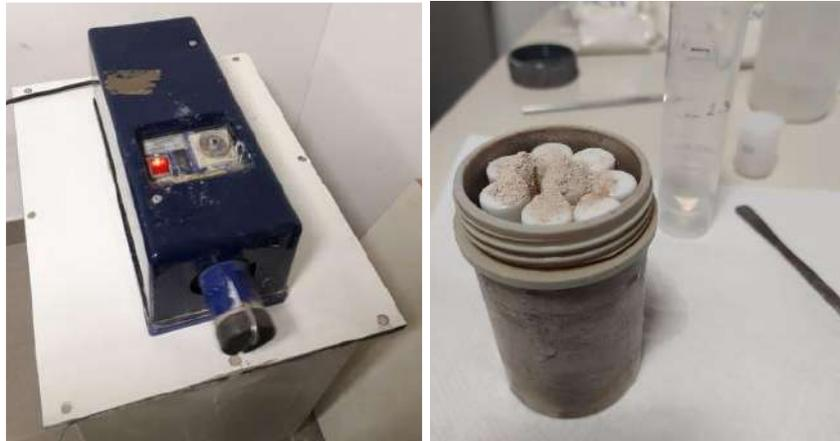
Figura 81 - Mulino micronizzatore e giara con dadi di zirconia
