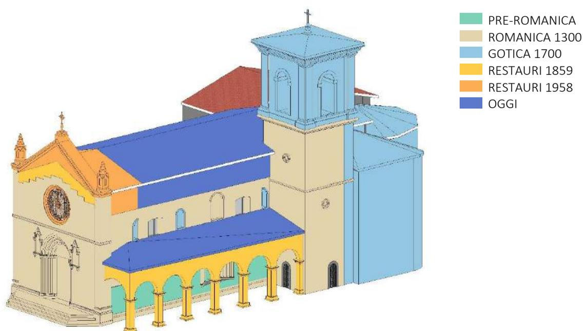
Figura 29 - Modello *Revit* della Basilica di San Benedetto in stato pre-sisma, evoluzione storica
