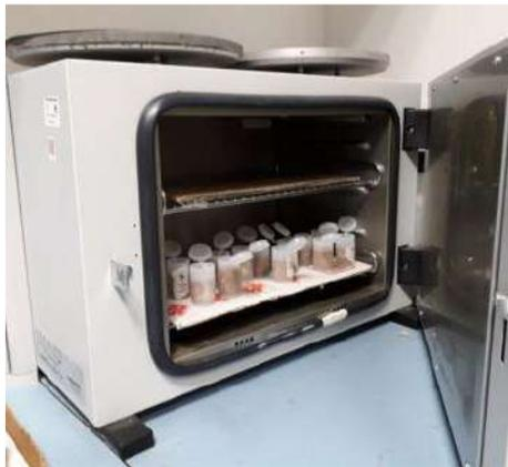
Figura 90 - Indurimento della resina in forno
