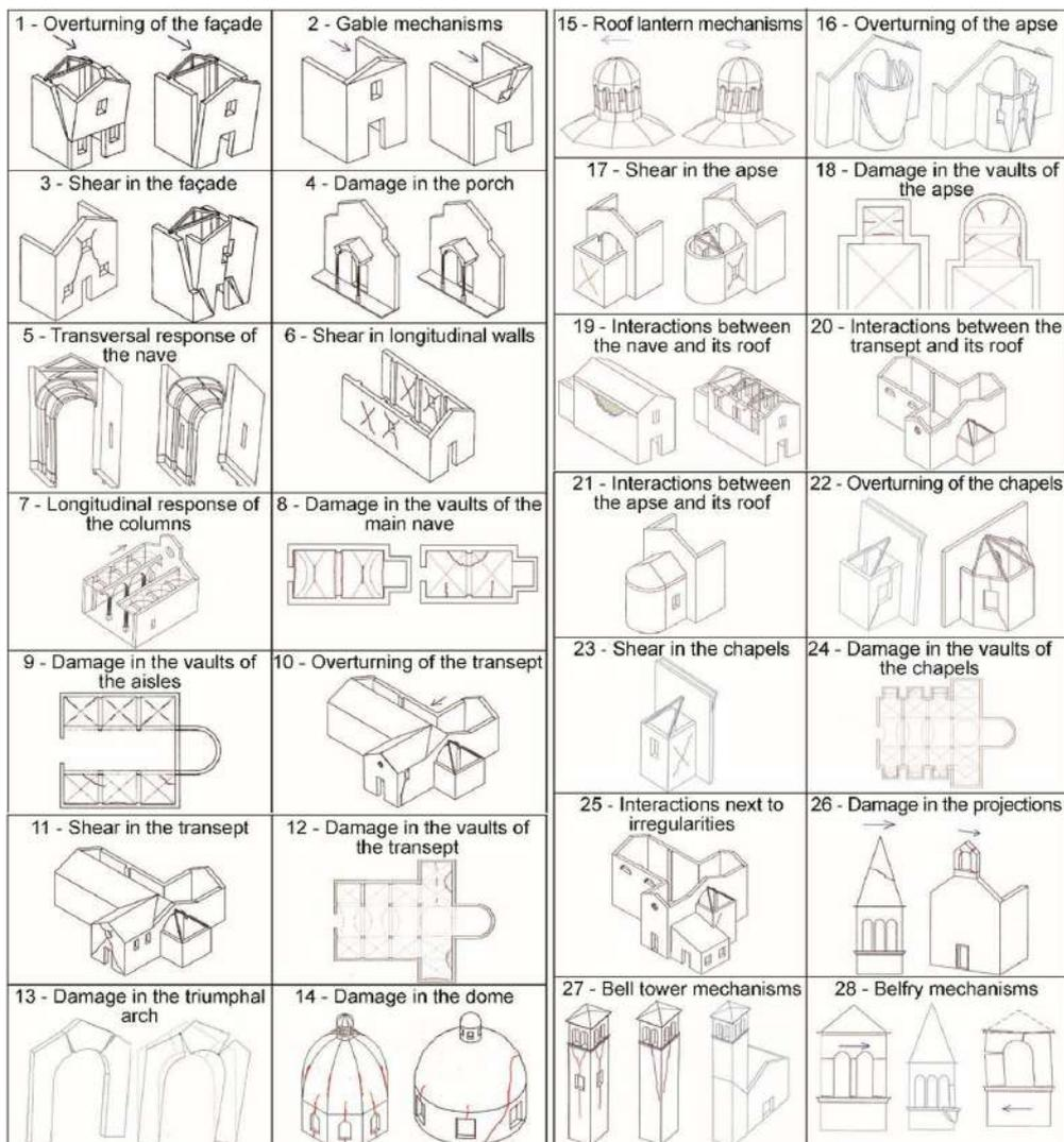
Figura 3 - Macroelementi e meccanismi di danno per le chiese [Doglioni et al., 1994]
