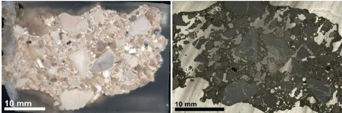
Figura 101 - Campione SB\_10, sezione trasversale (sx) e campione SB\_10, micrografia ottica a luce trasmessa, nicols paralleli
