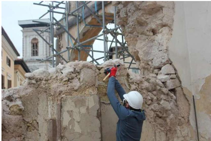
Figura 64 – Esecuzione di un prelievo di materiale legante nella Basilica di San Benedetto
