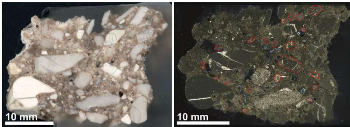
Figura 100 - Campione SB\_25, sezione trasversale (sx) e Campione SB\_25, micrografia ottica a luce trasmessa, nicols incrociati
