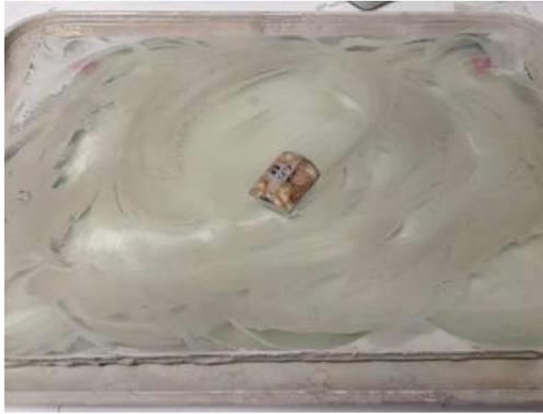
Figura 94 – Lappatura manuale con polvere di carburo di silicio e acqua
