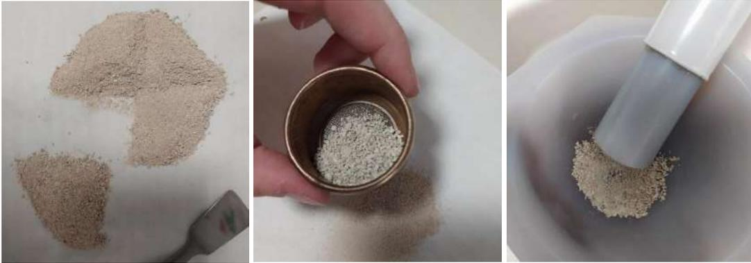
Figura 80 - Quartatura, setacciatura e utilizzo di mortaio e pestello
