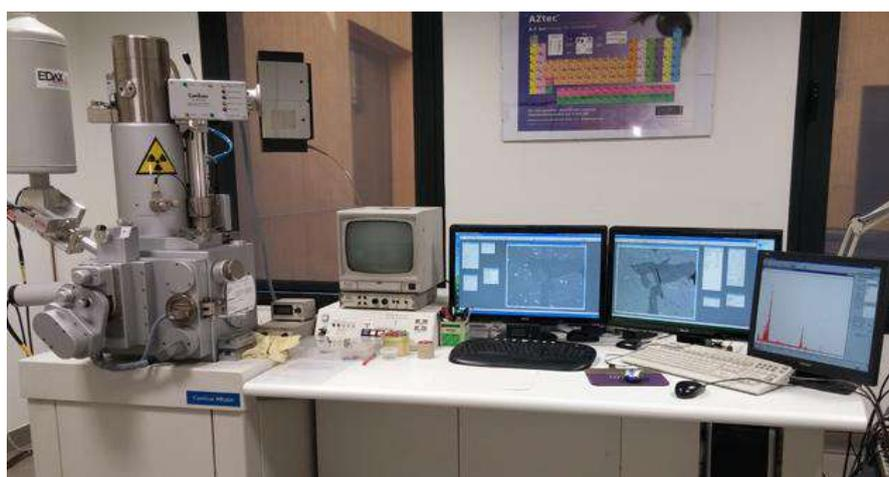
Figura 16 - SEM, CamScan MX3000 con sorgente LaB6
