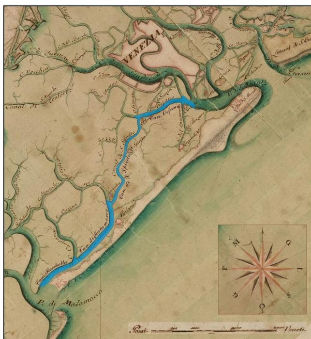
**Figura 1.8:** Il tracciato del canale navigabile di S. Spirito, realizzato nel 1726 per collegare il porto di Malamocco a Venezia, evidenziato sulla carta di Angelo Emo (1763) (Tratta da: "Fatti e misfatti di idraulica lagunare", D'Alpaos, 2010)
