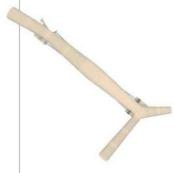
mento si biforca nelle rampe che confluiscono l'una in Rio Terà Foscarini e l'altra in Campo della Carità, sarà realizzata, in corrispondenza al cavalletto, una cerniera cilindrica con asse verticale in modo da meglio ripartire la componente di spinta sulle due ramificazioni della nuova sovrastruttura ed evitare sollecitazioni flesso-torsionali parassite sulla piastra ortotropa.
