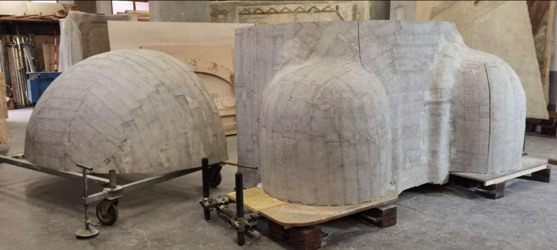
Due delle 5 parti della calotta di fibro-resina pronte per il montaggio
