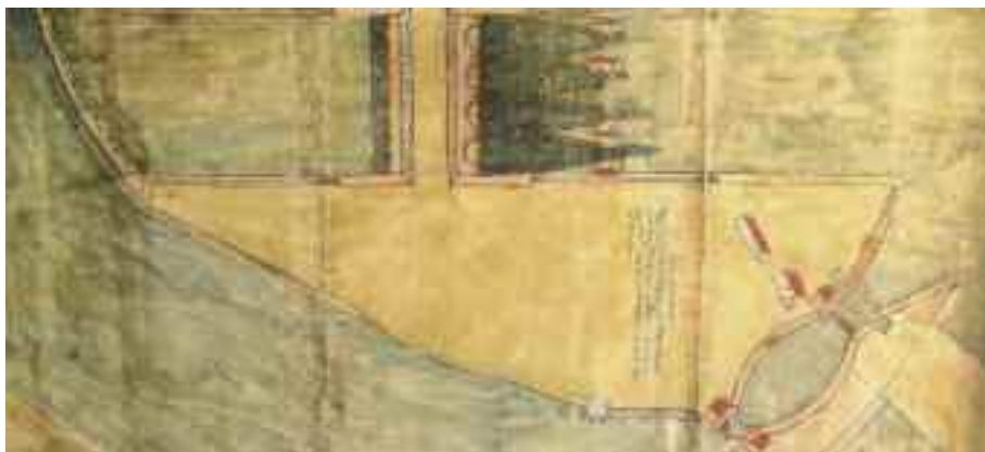
Progetto per la costruzione dei mulini di Dolo presentato nel 1550 da Cristoforo Sabbatino (Archivio di Stato di Venezia, SEA, Brenta, dis. 16). Il disegno è stato ruotato di 90° a dx. Da notare la conca con l'evidenza del portone, a monte del manufatto, a due ante.
