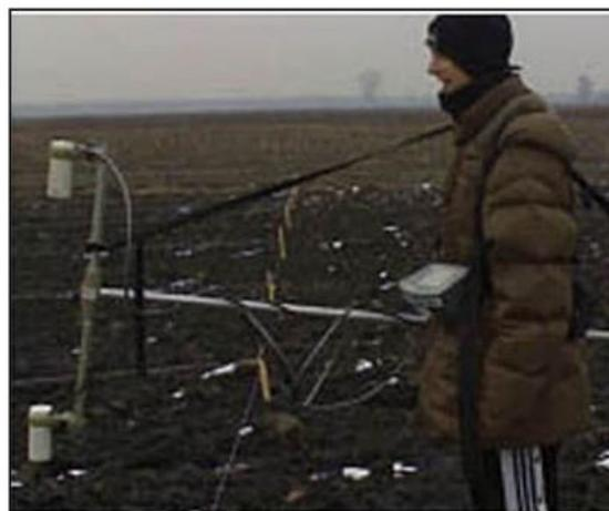
Magnetometro al cesio G858 in configurazione "gradiometro"
