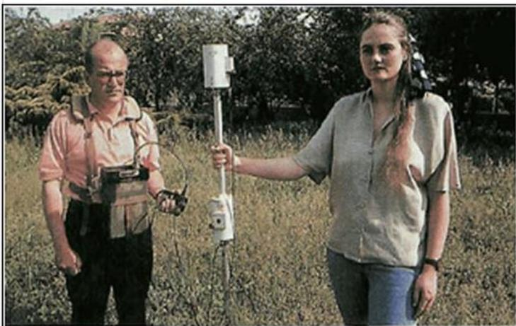
Magnetometro a protoni G856 in configurazione "gradiometro"
