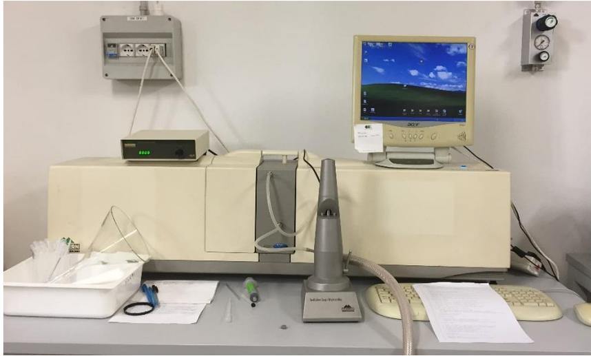
*Figura 29: Foto del Mastersizer 2000 che è stato utilizzato per effettuare l'analisi granulometrica dei campioni.*
