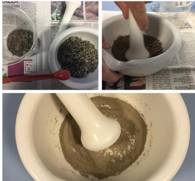
*Figura 23: Sequenza della macinazione di un campione eseguita in laboratorio.*
