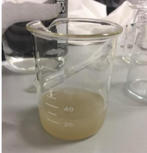
*Figura 31: Foto del becher contenente il campione con acqua deionizzata, prima di iniziare l'analisi granulometrica.*
