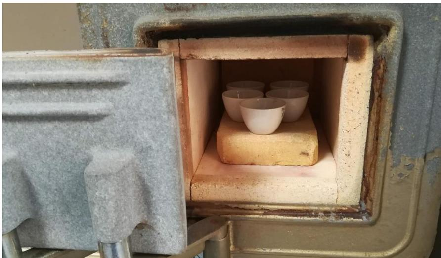
*Figura 24: Crogioli in porcellana, contenenti i campioni precedentemente macinati, disposti all'interno del forno a muffola.*
