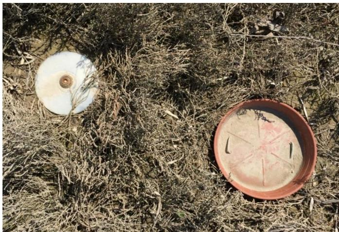
*Figura 17: Foto di una stazione del transetto 3 sulla barena di San Felice, scattata ad Aprile 2019 durante il campionamento, dove si vede che sia il CD che il sottovaso hanno raccolto del sedimento.*
