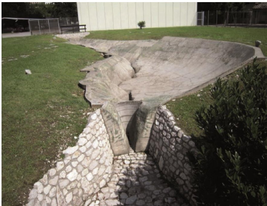
Figura 5. Modello idraulico in scala 1:200 del bacino del Vajont
